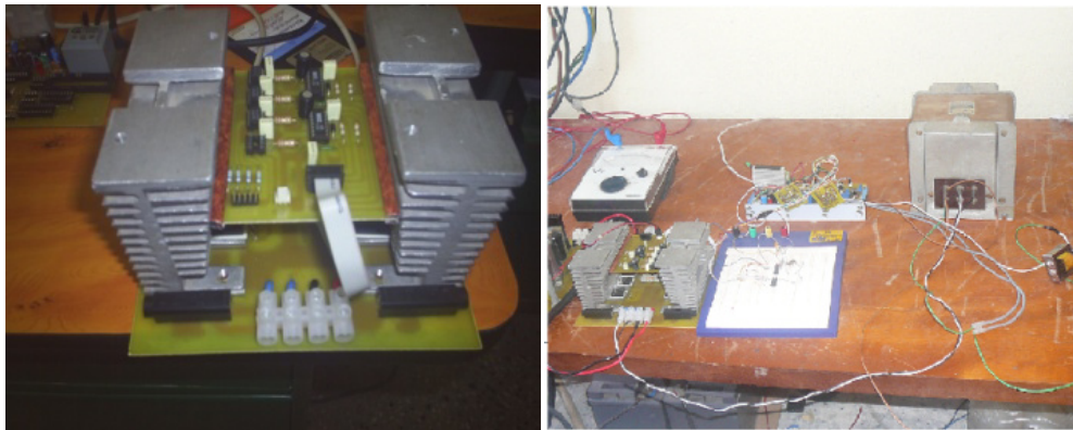
Figure III.25: Banc d'essai de l'onduleur réalisé.
