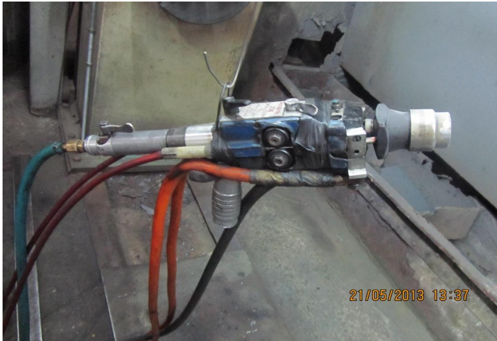
Figure IV.6 : Pistolet de projection à arc entre deux fils « ARC SPRAY 234».
