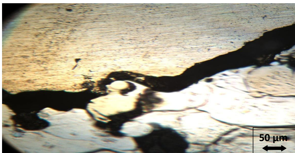
Figure V.12 Micrographie de l'AG3/NiAl/Thermanite après sollicitation mécanique.
