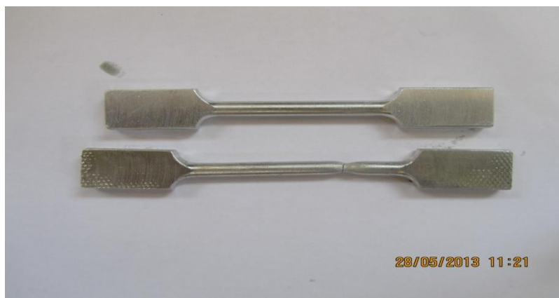
Figure V.2 comparaison des éprouvettes avant et après rupture.
