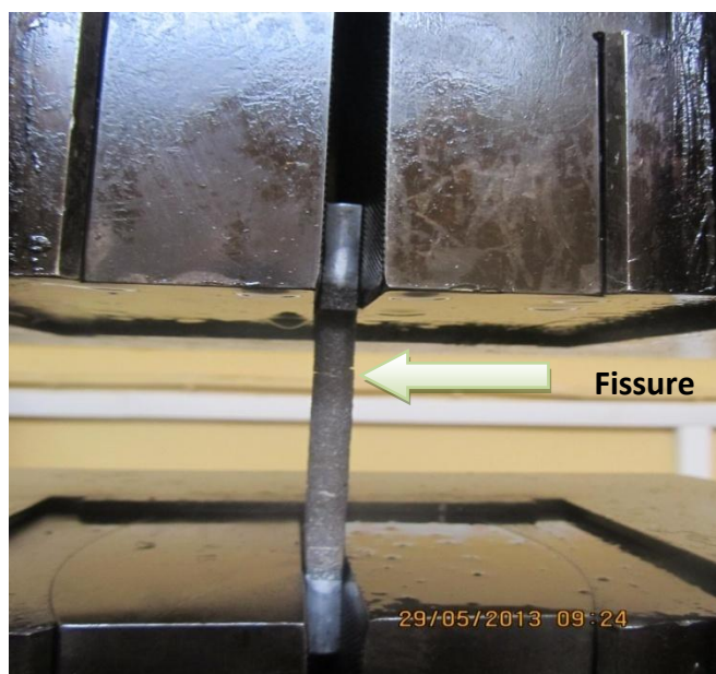
Figure V.5 amorçage de fissures lors de l'essai.
