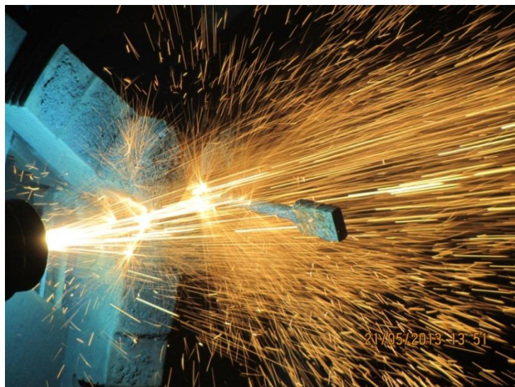
Figure IV.7 : Fonctionnement du pistolet a arc électrique.
