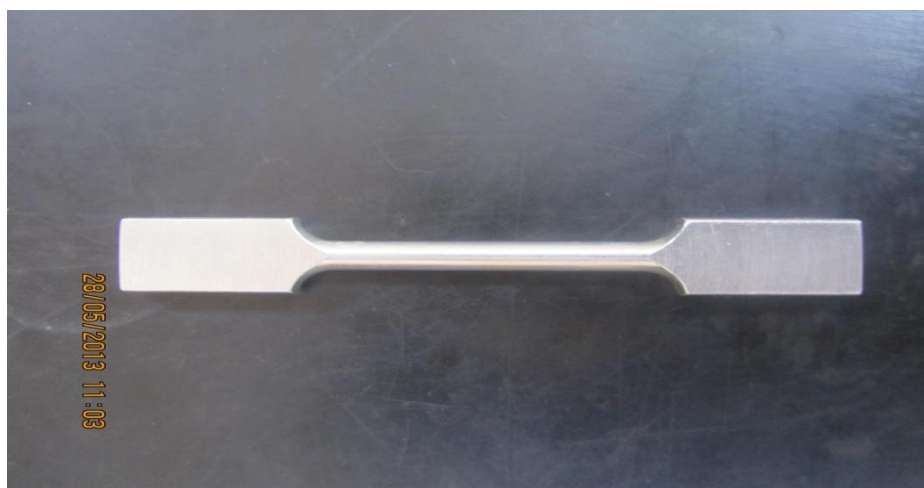
Figure IV.2. Epreuve de traction avec méplat.
