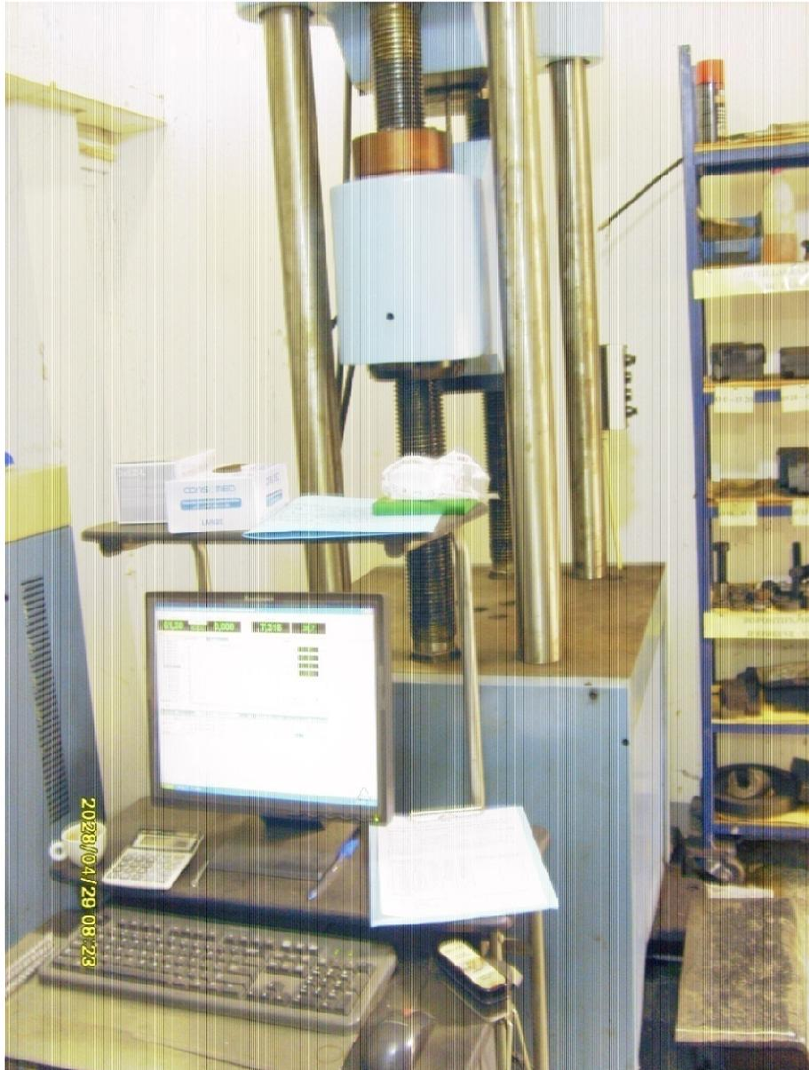
Figure. II.6 : Le micro-ordinateur équipé de logiciel Winwew relié à la machine universelle hydraulique pour l'acquisition et l'exploitation des données.
