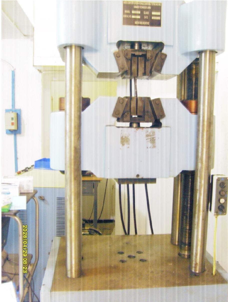
Figure II.5 : Machine d'essais universelle hydraulique utilisée pour l'exécution de nos essais de traction.
