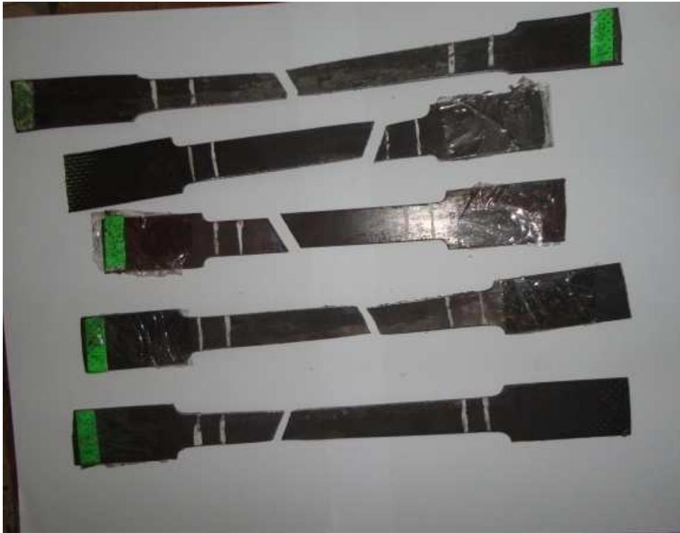
Figure III.1 : Eprouvettes rassemblées après l'exécution de l'essai de traction
