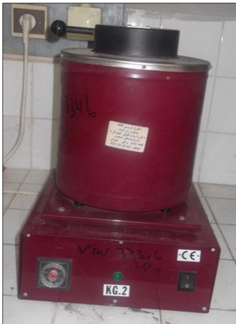
Figure II.4 Le four à creuset.
