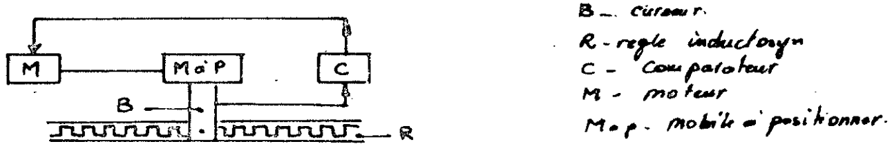
fig 18 schématisation d'une mesure analogique avec règle inductosyn.
