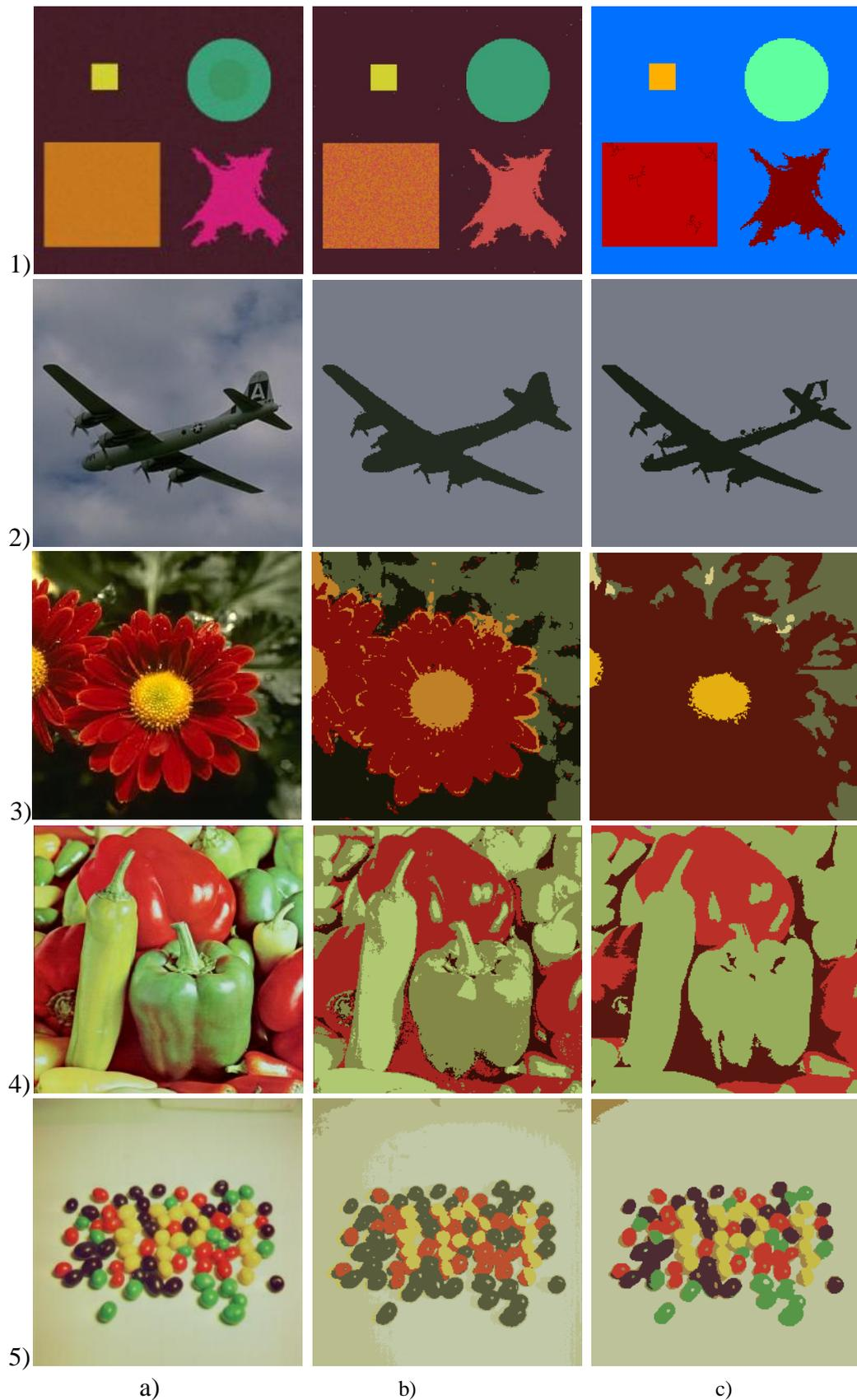
Fig. II.8 : Résultats de la segmentation par l'algorithme EM des images couleur
