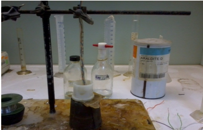
Figure IV.1- Opération d'enrobage d'une électrode.
