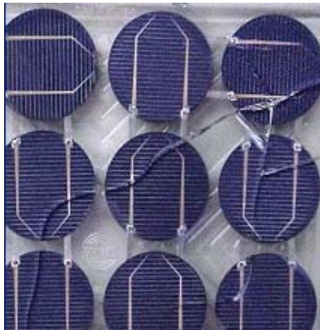
Figure IV.3: Effet du point chaud sur les modules photovoltaïques
