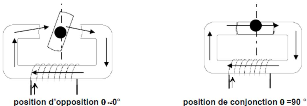
**Figure I-2 Structure de la MRV de base et positions extrêmes du rotor.**
