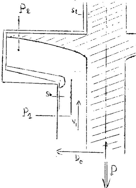
Pour réduire la poussée axiale (surtout si elle est importante), on utilise une garniture d'équilibrage. Pour cela, on perce l'ouïe de la roue de trous, pour que derrière ce barrage puisse regner la pression d'aspiration  $p_1$ , le diamètre de la garniture peut être celui de la garniture d'ouïe.
