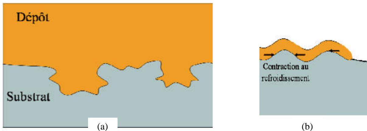
Figure III.5 : Illustration de l'accrochage mécanique [37].
