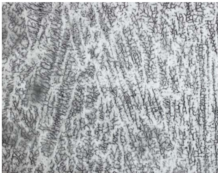
Figure IV.7 : Ech-B - Structure du cordon de soudure (G=200).
