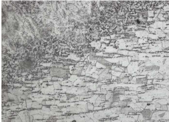
Figure IV.8 : Ech-B - Structure de la zone affectée thermiquement (G=200).
