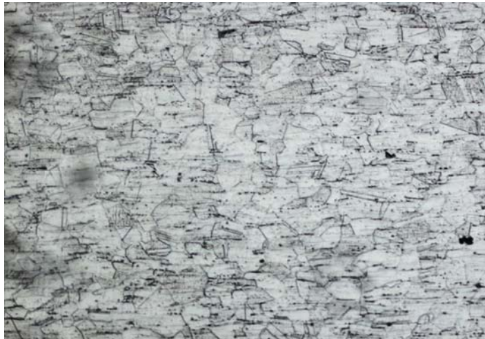
Figure IV.9 : Ech-B - Structure du métal de base (G=200).
