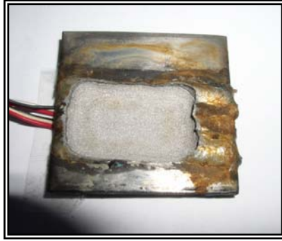
Figure III.9 : Echantillon après usinage par polissage électrolytique
