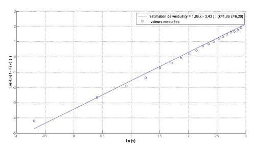
Figure III.4 Droite de régression : Ln(-Ln(1-F)) = a.Ln(v) + b
