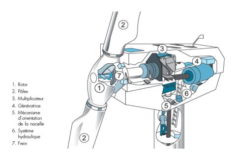
Figure I.13 Les éléments constitutifs d'une éolienne [13]
