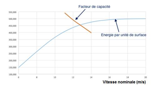
Figure IV.1 Evolution de l'énergie électrique et du facteur de capacité avec la vitesse nominale de vent
