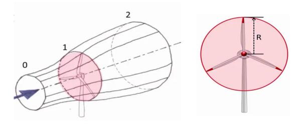
Figure I.18 Le tube d'écoulement d'air à travers l'éolienne [01]
