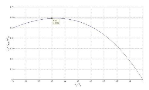
Figure I.19 Coefficient de puissance Cp en fonction du rapport V<sub>2</sub>/V<sub>0</sub>
