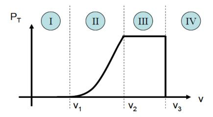
Figure I.22 Zones de fonctionnement d'une éolienne [06]
