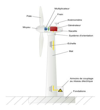
Figure I.11 Eolienne à axe horizontal
