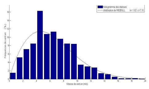
**Figure III.6** Distribution de Weibull calculée par la méthode du maximum de vraisemblance
