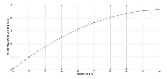
Figure III.11 Evolution de la vitesse moyenne avec la hauteur
