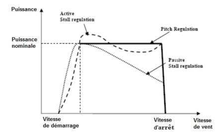
Figure I.23 Les différentes méthodes de commande de la puissance active dans un capteur éolien [20]
