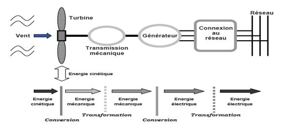
Figure I.10 Principe de conversion d'énergie dans une éolienne [2]
