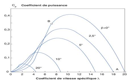
Figure I.25 L'influence de l'augmentation de l'angle de calage sur le coefficient de puissance [05]
