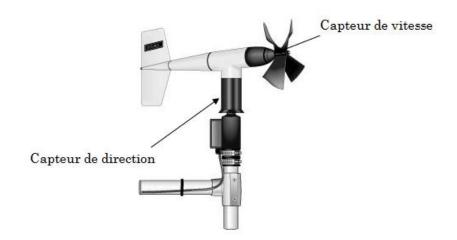
Figure II.2 Anémomètre à hélice.
