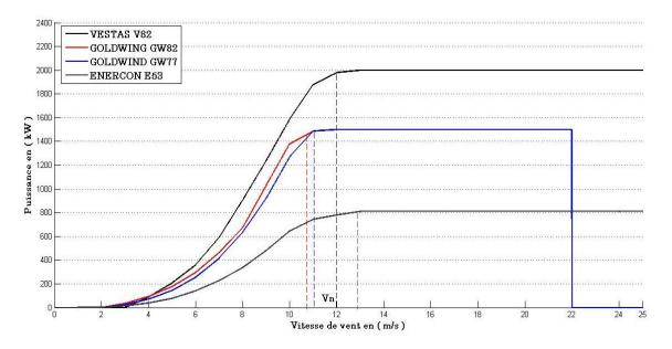
Figure IV.2 Courbes de puissance pour certains constructeurs
