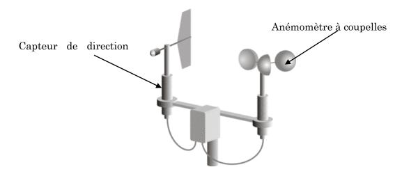
Figure II.3 Anémomètre à coupelles.
