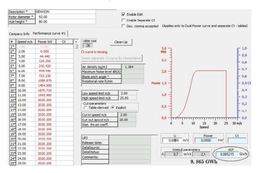
**Figure IV.4 :** Courbe de puissance et énergie annuelle produite « AEP » en utilisant WASP pour l'éolienne SENVION MM92
