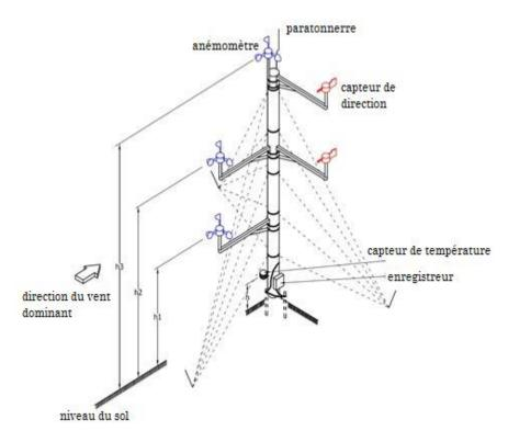
Figure II.1 Mât de mesure
