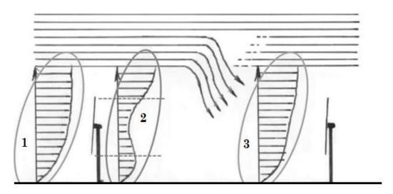
Figure II.6 Influence de l'espacement des éoliennes sur les profils d'air [01]
