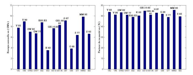
Figure IV.3 Energie annuelle et facteur de capacité pour toutes les éoliennes utilisées
