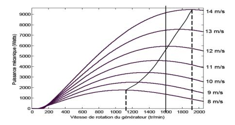
Figure I.21 Puissance théorique disponible pour différentes vitesses de vent [05]
