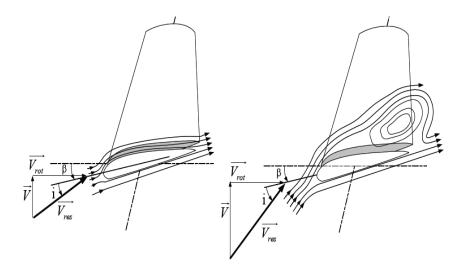
Figure I.24 Flux d'air sur un profil de pâle "stall"[05]
