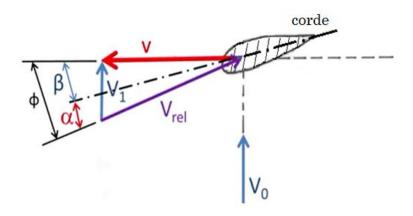
Figure I.15 angles et vitesses du vent sur le profil [01]
