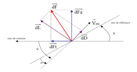
Figure I.17: Forces appliquées sur un élément de pâle [06]
