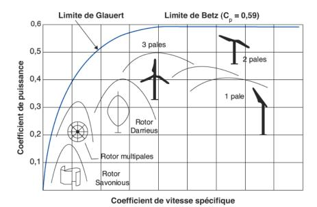
Figure I.20 Coefficient de puissance en fonction de la vitesse spécifique pour différents types d'éoliennes [13]
