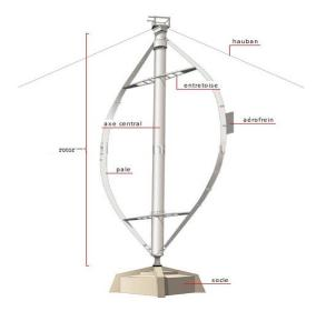
Figure I.12 Eolienne à axe vertical
