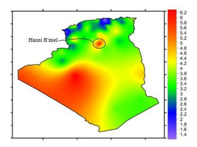
Figure III.2 Carte des vitesses de vent à 10m du sol [11]
