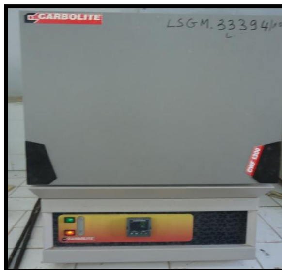
Figure IV.3. Four utilisé pour le recuit de cristallisation (Carbolite).
