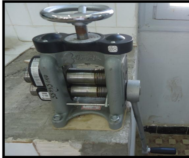
Figure IV.2. Photo du laminoir manuel utilisé.
