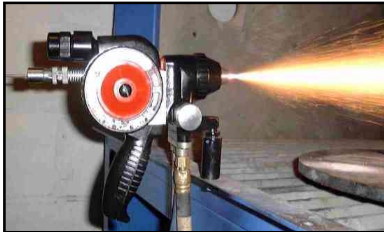
Figure III.1 : Pistolet de projection à arc électrique « Arc spray 234 » ayant servi à la projection de l'acier inoxydable 55E
