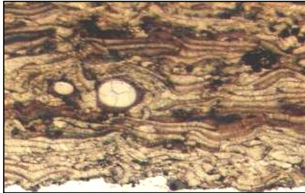
Figure I.12 : Microstructure d'un dépôt de molybdène réalisé par le procédé plasma [4]
