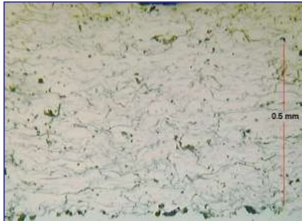
Figure 1.16 : Microstructure d'un dépôt de Cr projeté à l'arc électrique [4]
