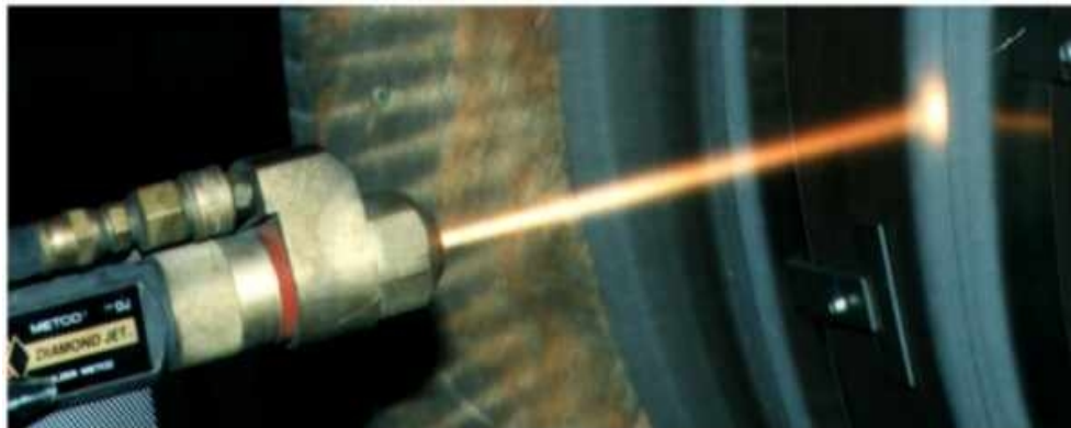
Figure I.7 : Procédé HVOF en cours de fonctionnement [4]
