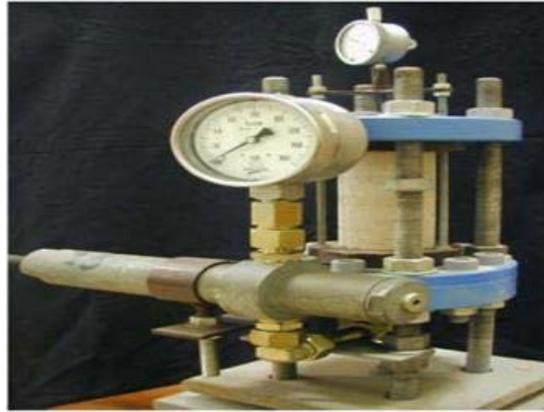
Figure II.7: Dispositif expérimental de la compression
