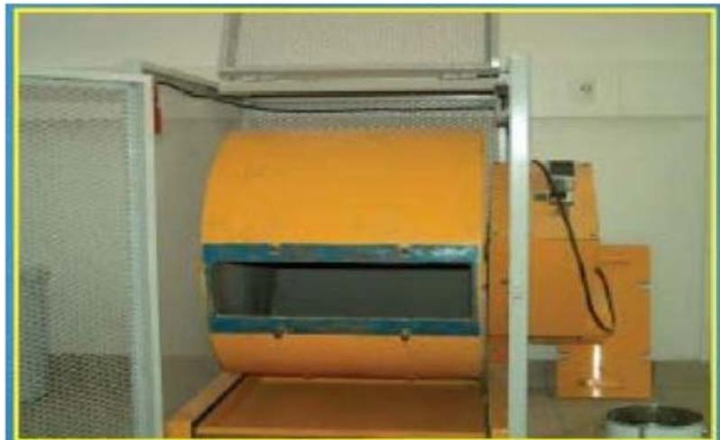
**Figure II.3:** Machine Los Angeles (le diamètre du tambour est d'environ 71 cm).
