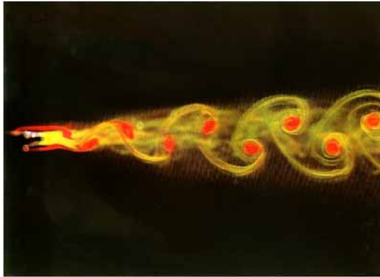
FIGURE 2.2 – Tourbillons générés suite à l'écoulement autour d'une plaque plane (www.effluids.com)
