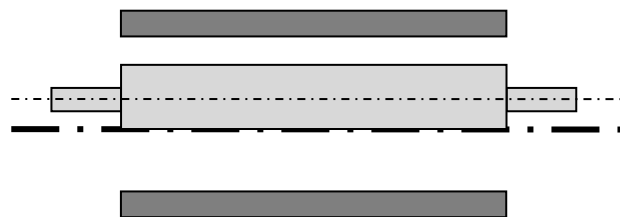
Figure IV.2 : Phénomène d'excentricité du rotor
