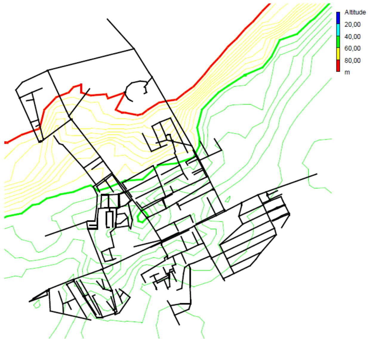
Figure 5.4 : Courbe de niveau des altitudes des nœuds tirés du modèle hydraulique sous EPANET (réseau de BIR TOUTA ville)
