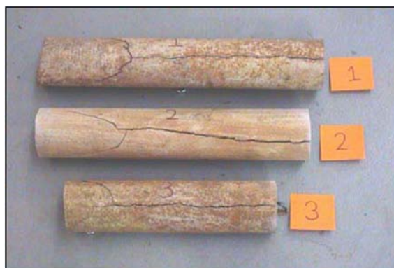
Figure 4.4 : Echantillons de conduites en amiante –ciment utilisées pour les essais [Greyvenstein et Van Zyl, 2005].
