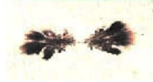
Figure I.11 : Exemple d'arborescences d'eau en nœud-papillon développées dans un échantillon mince de câble de 35 kV d'épaisseur 10 µm [Ahm05]
