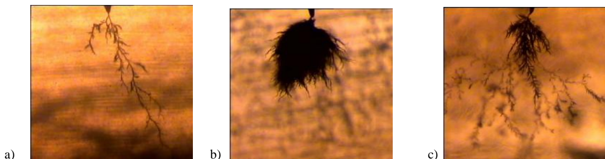
Figure I.15 : Trois formes d'arborescences électriques dans le XLPE : (a) branche, (b) buisson et (c) mixte en buisson-branche [Zhe08]
