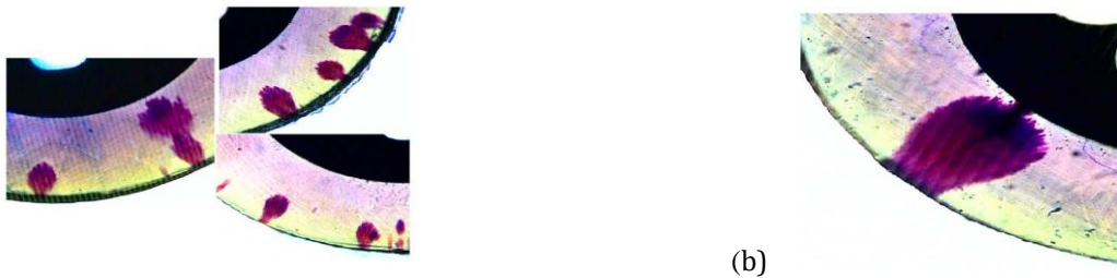
Figure I. 8: Arborescence d'eau évoluant à partir de l'écran semi-conducteur : (a) arborescence à ses début et (b) arborescence ayant provoqué le claquage de l'isolation [Dal02]
