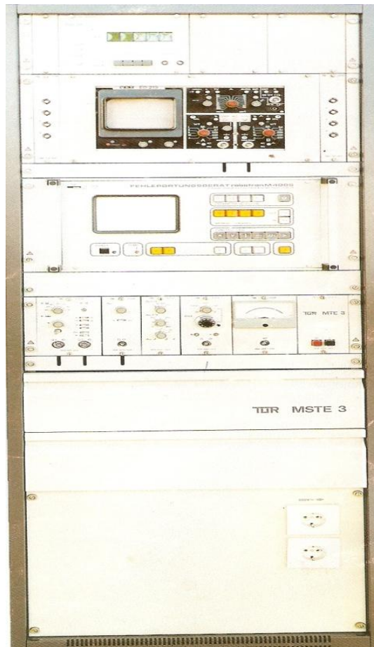
Figure II.9 : Photo de l'unité MSTE 3 de mesure des décharges partielles
