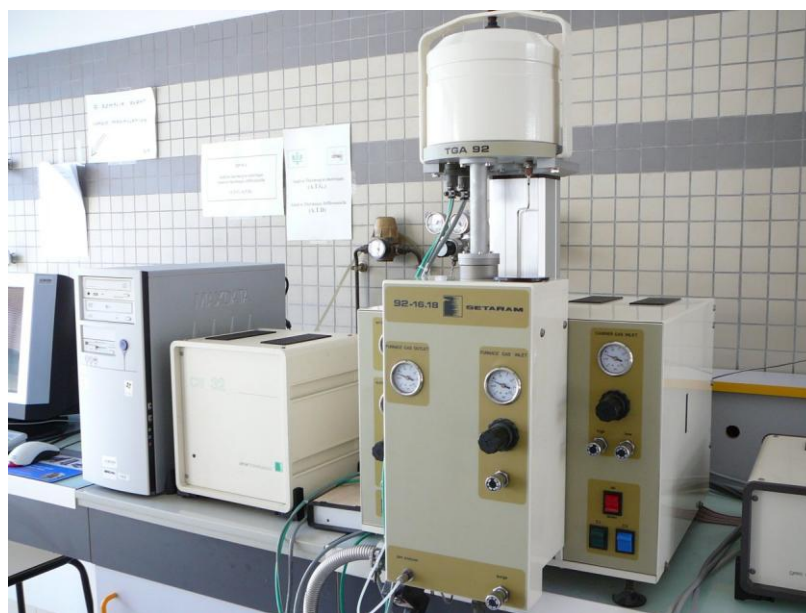
Figure IV.23 : Photo d'ensemble de l'appareillage de l'ATG/ATD
