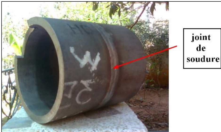
Figure III.1. Les deux tubes soudés à l'état reçu.
