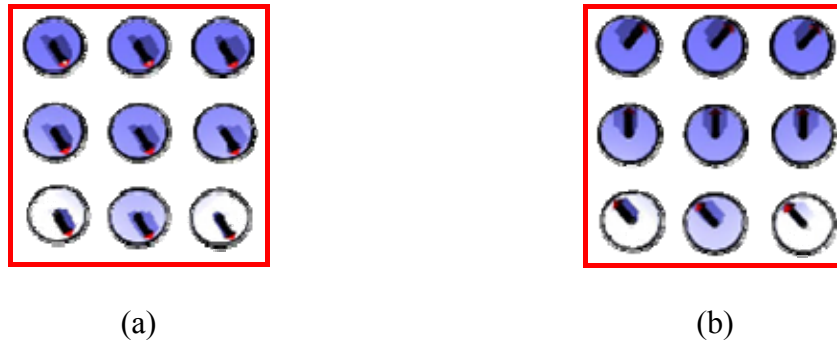
FIG.1.16 – Gradient de codage de phase. (a) Les protons ont la même phase, (b) les protons d'une même ligne ont des phases identiques.
