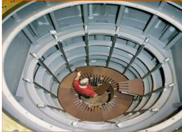
Fig.I.12. Ensemble noyau-disque du stator [9]
