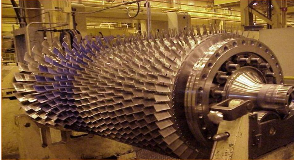
Fig.I.5. Compresseur à 18 étages, modèle GE [4]
