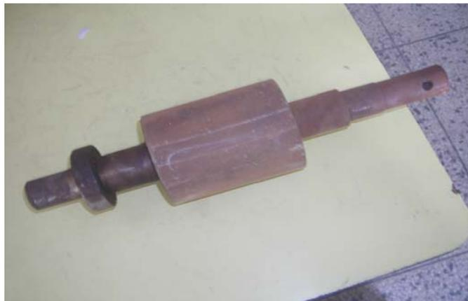
Fig. IV.1. Rotor massif utilisé.
