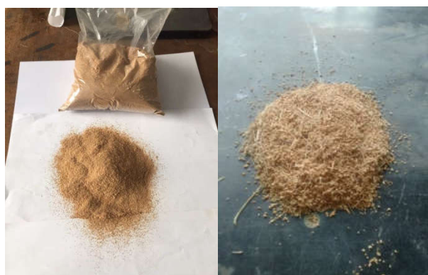
Figure 1.8: Produits résidu du broyage après tamisage avec deux dimensions, (a) calibre 1; (b) calibre 2.
