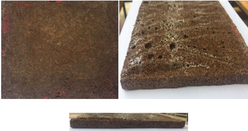
Figure 1.12 : Produit final de la mousse du sandwich.
