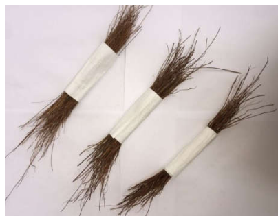
Figure 1.3 : Les fibres de surface de palmier dattier après défibrage en différents calibres selon leurs diamètres.
