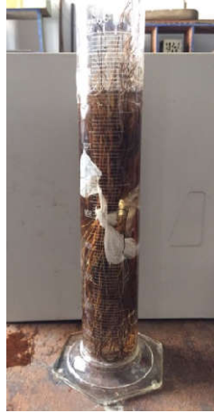
Figure 1.4 : Traitement des fibres avec une solution alcaline NaOH.
