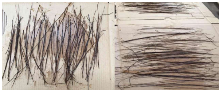
Figure 1.5 : Séchage des fibres après traitement à l'air libre.
