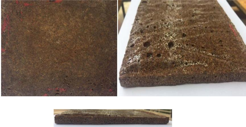
**Figure II.6** : Produit final de la mousse du sandwich.
