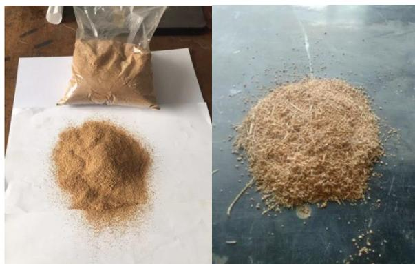
**Figure II.2** : Produits résidu du broyage après tamisage avec deux dimensions,(a) calibre 1;(b) calibre 2.
