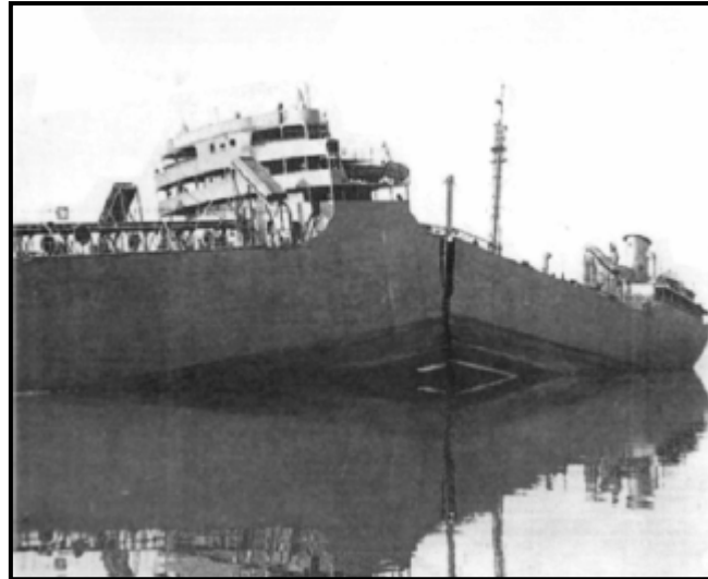
Fig. 1. Rupture fragile d'un liberty-ship (après la seconde guerre mondiale) au cours d'un hiver rigoureux [Hac-2007].
