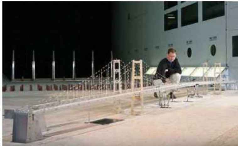
Figure 1-1 : Test en soufflerie d'un modèle du pont de Tacoma de 1940
