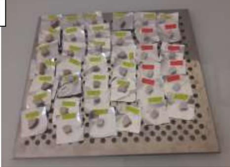
Mettre l'échantillon dans l'étuve à une température de 55 °C pendant 48 heures.
