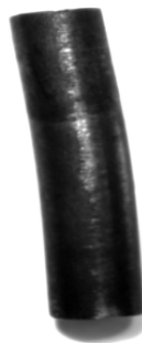
Figure 5.8 : Poinçon supérieur flambé
