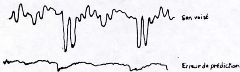
Fig. 4.3 : Echantillon d'un son voisé et erreur de prédiction correspondante. L'erreur est petite sauf au moment où apparaissent les impulsions du fondamental. Il est ainsi possible de mesurer la hauteur du son, en examinant le signal d'erreur, indirectement à travers sa fonction d'autocorrélation.
