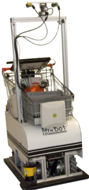
Fig. 1.1 : Prototype de caddy intelligent « Inbot »
