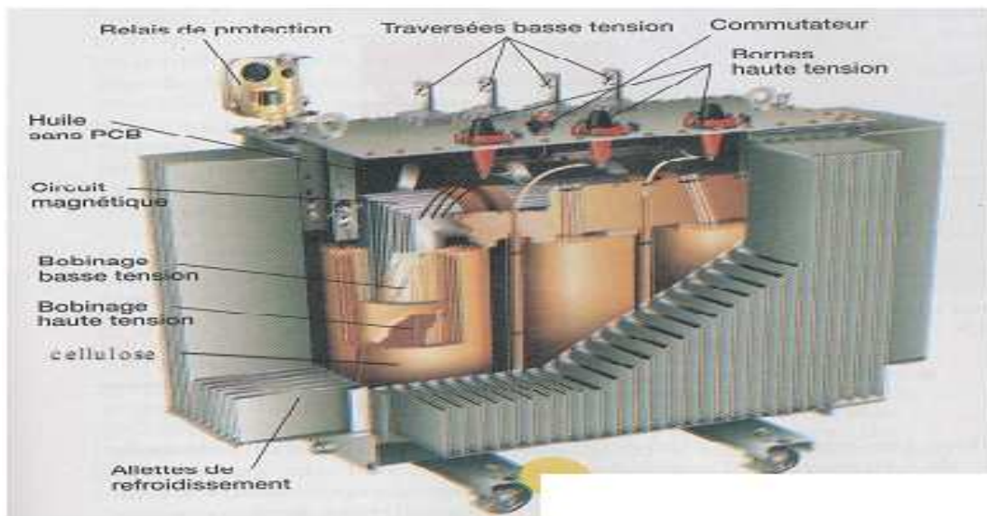
Figure 1.2 : Vue intérieur d'un transformateur, type colonne. [1.3]
