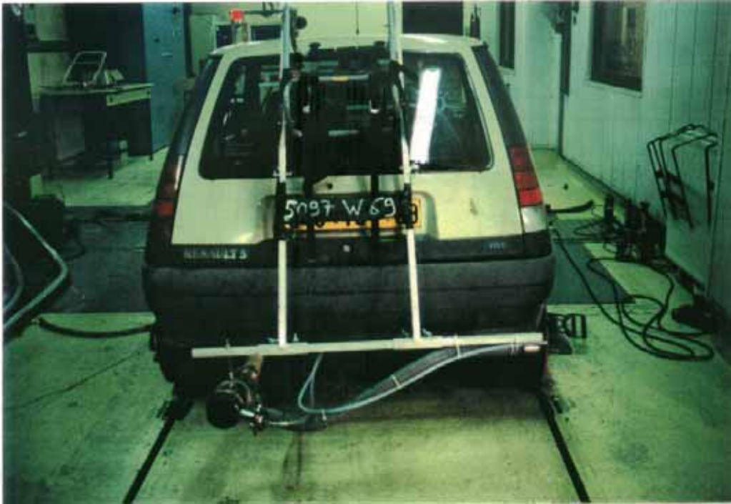
Figure 34 : Photo du véhicule équipé de capteurs et du Mini CVS à l'INRETS (Vidon, 1996)
