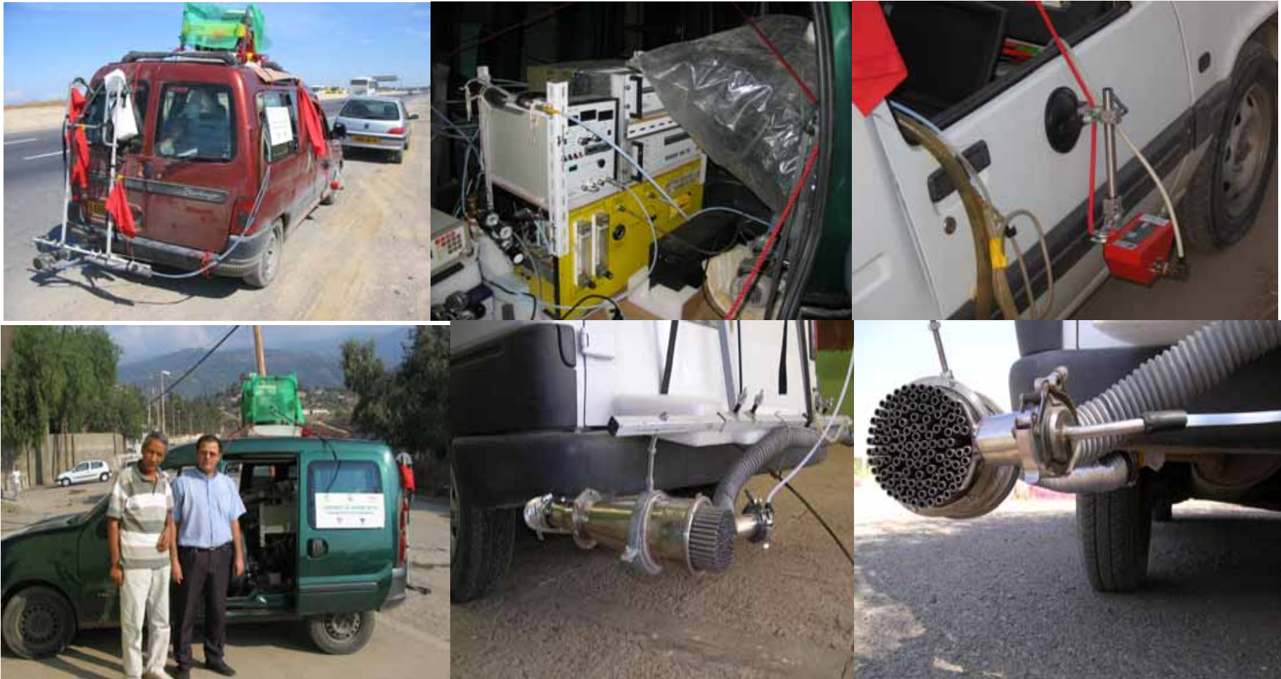
Figure 39 : Photos du montage expérimental de mesure embarqué en circulation réelle
