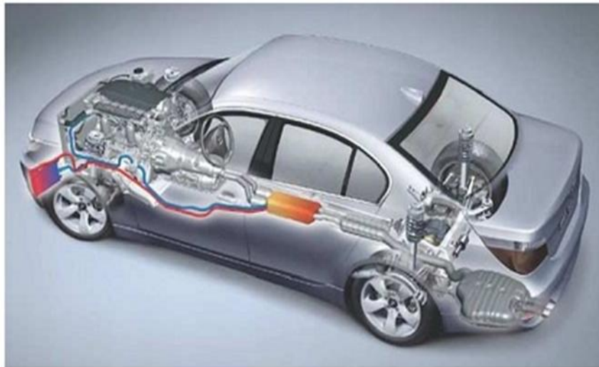
Figure II.11 : Conception d'un générateur thermoélectrique produisant de l'électricité de la chaleur perdue au niveau du pot d'échappement d'un véhicule (source BMW).
