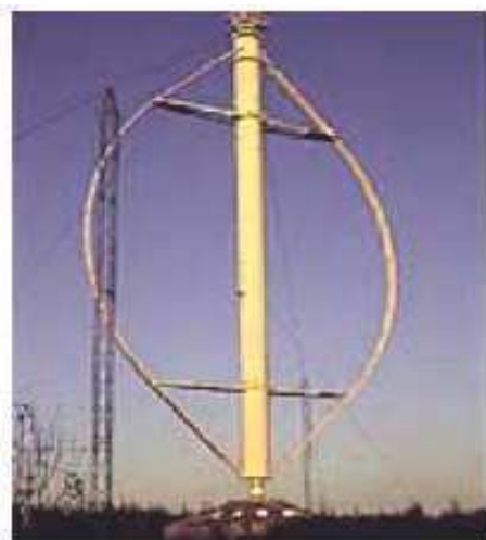
Aérogénérateur à axe vertical
