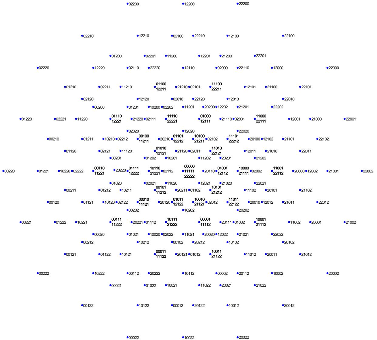
**Fig.3.27.** : Représentation des vecteurs « tension » d'un onduleur cinq-phases 3 niveaux
