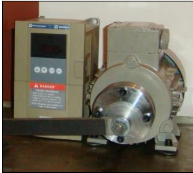
Figure 18 : Moteur et variateur de vitesse.
