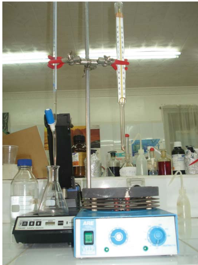
FIGURE III.8 – Système de neutralisation
