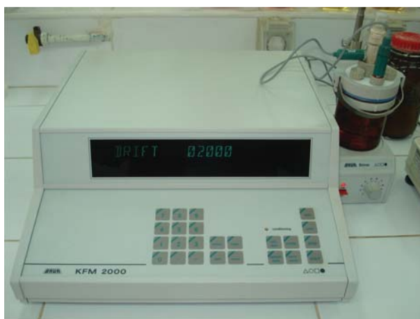
FIGURE III.9 – BAUR KFM2000 pour la mesure de la teneur en eau
