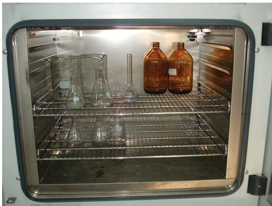
FIGURE III.1 – Etuve pour vieillissement de l'huile
