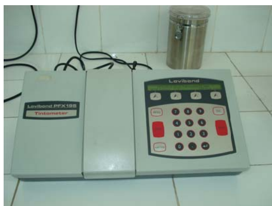
FIGURE III.10 – Tintomètre Lovibond PFX195 pour la mesure de l'indice de couleur
