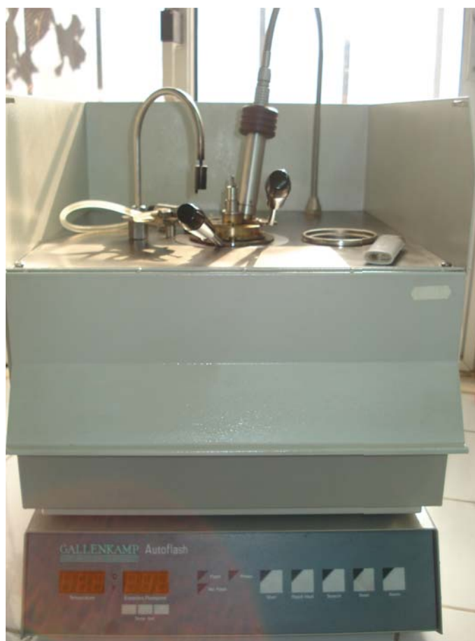
FIGURE III.11 – Autoflash GALLENKAMP AF3 pour la mesure du point d'éclair
