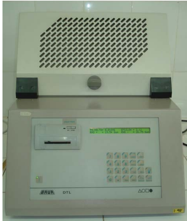
FIGURE III.3 – BAUR DTL pour la mesure du facteur de pertes et de la permittivité relative
