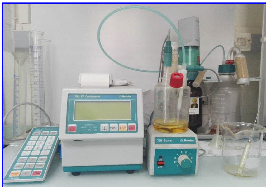
Fig.II.4 : Titrimètre de type 756 Karl Fisher
