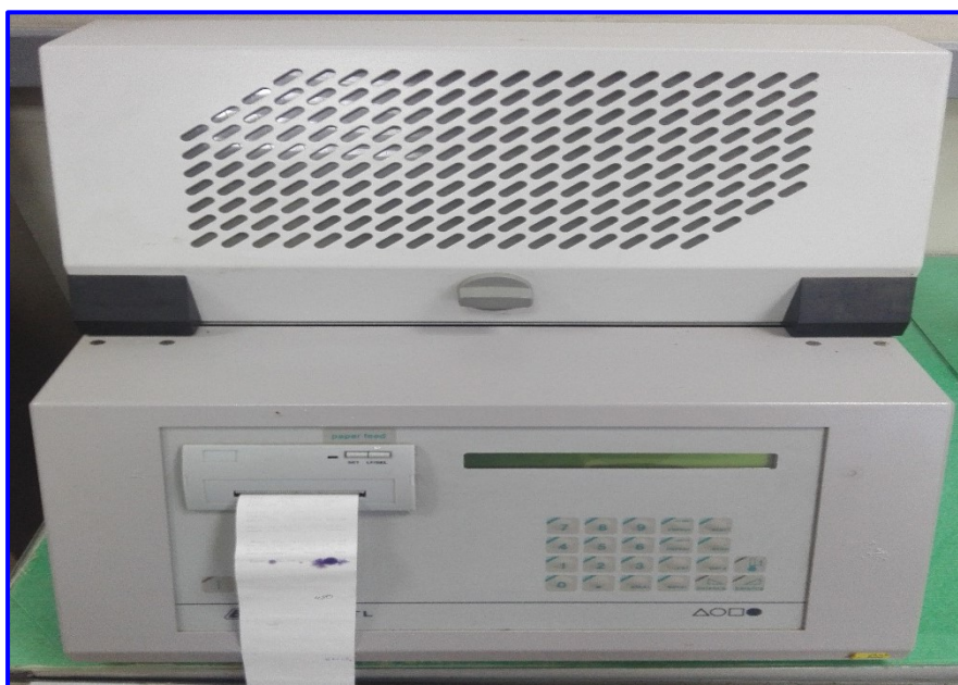
Fig.II.2 : Système de mesure du facteur de dissipation et de la permittivité relative de type BAUER DTL
