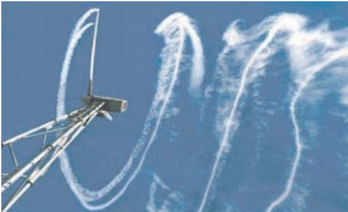
Fig. II.2. Expérience réalisée par le Centre danois de recherche sur l'énergie "Risø", montrant le sillage d'une éolienne à une seule pale [32].
