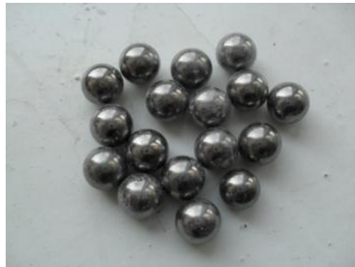
Figure V.43 Medias utilisés pendant les essais (billes en acier traité avec un diamètre de 10 mm)
