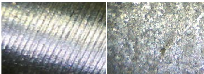
Figure V.44 Surface de l'éprouvette en alliage d'aluminium observée avec un microscope portable avant et après traitement
