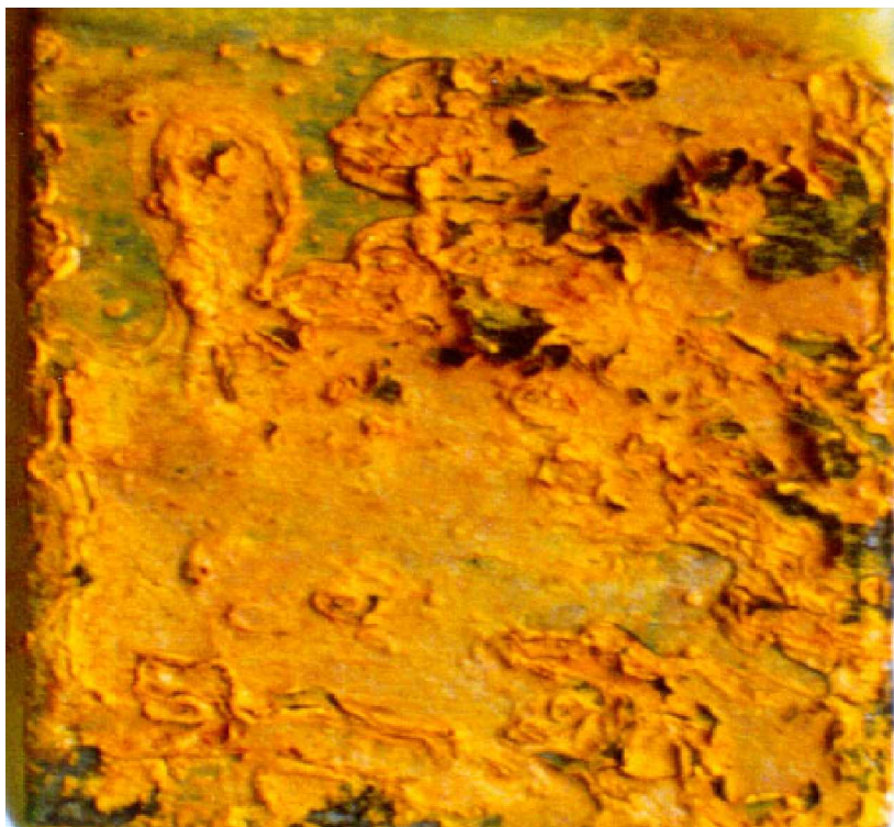
Image 4, après immersion pour 8h dans une solution blanche pH 4
