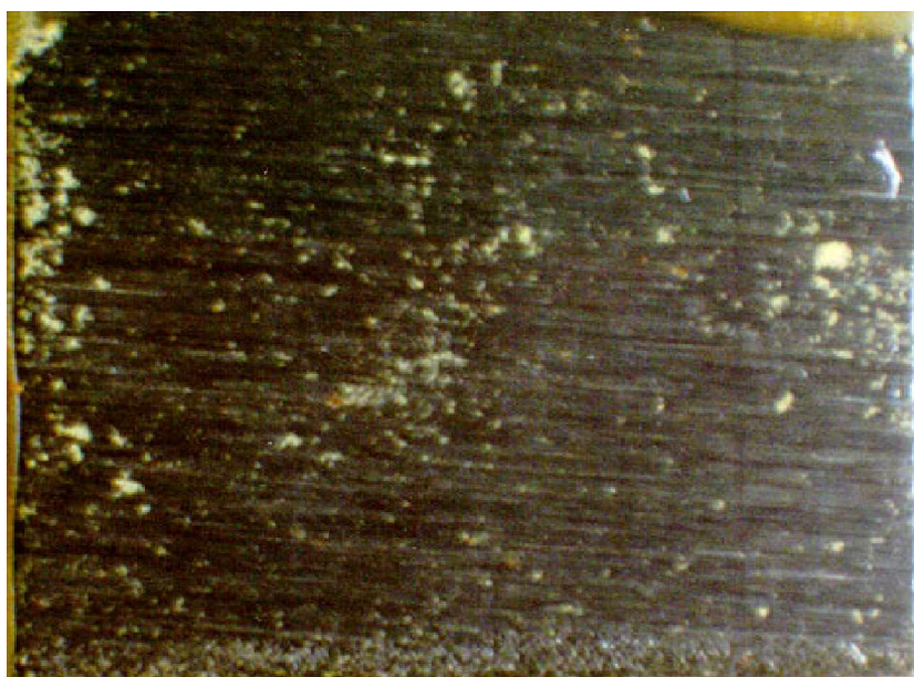
Image 1, après immersion pour 8h dans le chromate de strontium
