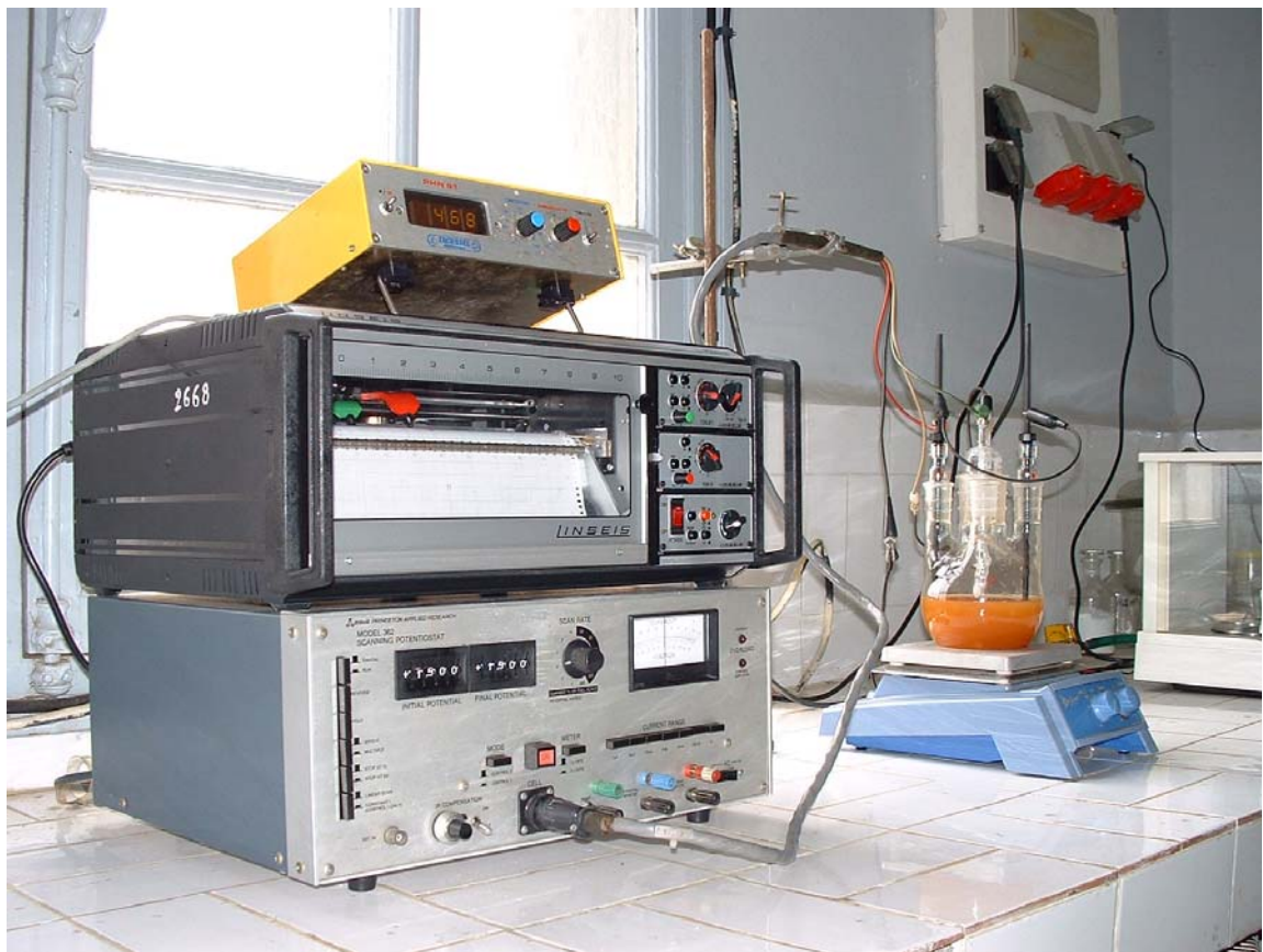
Fig. III.1 : Dispositif expérimental utilisé pour les essais électrochimiques et par immersion.
