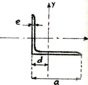
c/ Entrait:  $N = -5,7 \text{ t}f.$  (compression). On dimensionnera par le critère de stabilité: soit  $\lambda = 100 \rightarrow k = 1,894.$   $A_{nec} = k \frac{N}{\sigma_{en}} = 1,894 \frac{5700}{2400} = 4,5 \text{ cm}^2$  d'où un profilé L 70x70x7. (idem que l'arbalétrier).
