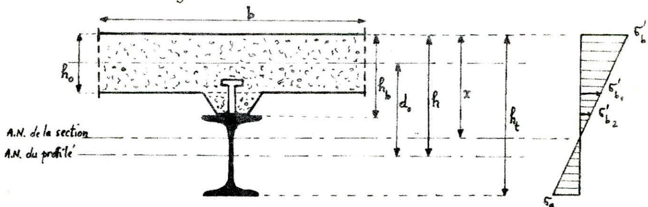
$$h = \frac{h_0}{2} + d_b . \quad B = b h_0 . \quad B_o = B + n.A .$$
