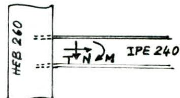
soit  $n=8$  boulons HR<sub>g-10</sub> Ø20 :
