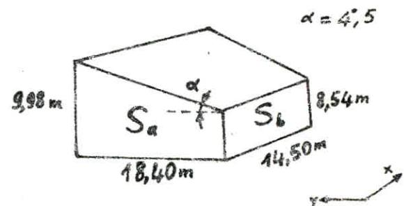
L'action globale est obtenue à partir de la pression dynamique par :  $Q = q_d \cdot C$  où  $C$  est le coefficient de pression.
