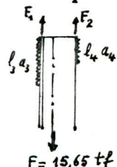
$$l_4 \geq \frac{4,4 \cdot 10^3}{0,75 \times 0,48 \times 2400} = 5,2 \text{ cm.} \quad L_4 = 5,2 + 1 = 6,2 \text{ cm.} \rightarrow L_4 = 7 \text{ cm.}$$
