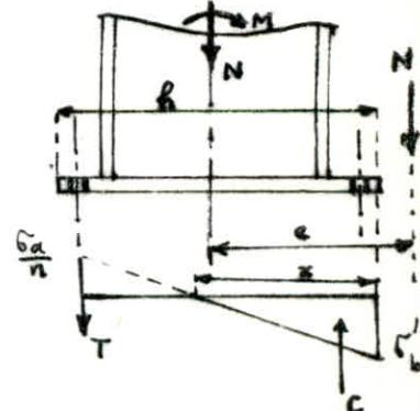
$\Omega = \text{somme des sections des boulons actifs} : \Omega = 4A_{tr}$
