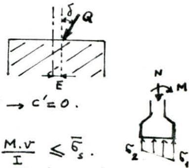
et on la remplace dans l'expression de Terzaghi donnant  $\bar{\sigma}_s$ . On obtient:  $A = 1,50m$
