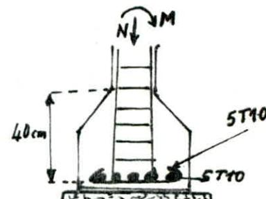
**VII/ CALCUL DU FÛT :** Les fondations doivent être ancrées à 1,20m. La semelle a pour hauteur totale  $h_f = 45$  cm. L'assemblage de la plateforme au massif doit être au-dessus du sol; on prévoit alors un fût en béton armé de hauteur 75cm et de section 70x50cm<sup>2</sup>. Ce fût est sollicité en flexion composée.
