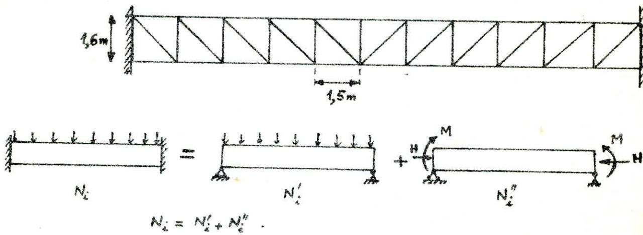
Dans un premier temps, on étudiera la ferme simplement appuyée ( $N'_i$ ), et après avoir déterminé  $M$  et  $H$  dans l'étude du portique, on déterminera  $N''_i$  et avec les efforts  $N_i = N'_i + N''_i$  on vérifiera les barres composant la ferme.
