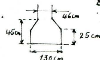
b) vérification de la stabilité:  $e = 0,17 \text{ m} < \frac{A}{6} = 0,21 \text{ m}$ .
