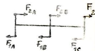
• Niveau 0 :  $M_{0A}^n = M_{0c}^n = F_{1A} \times 0,6 h_1 = 1,29 \times 0,6 \times 3,52 = 2,72 \text{ tm.}$
