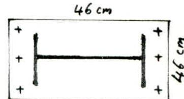
$$- \text{excentricité : } e = \frac{N}{N} = \frac{28,3}{28,3} = 0,28 \text{ m} > \frac{h_0}{2} = 0,23 \text{ m}$$
