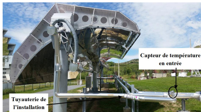
Figure 4.19. Emplacement du capteur de température par rapport de la sortie de fluide caloporteur.
