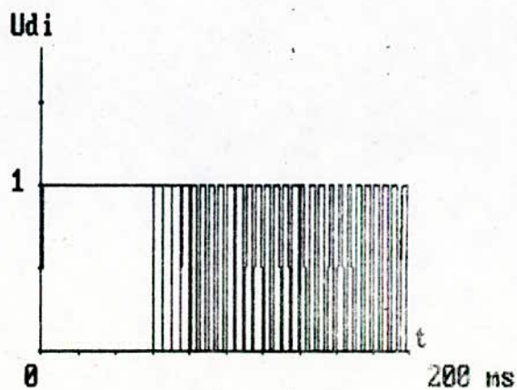
Fig 5-3. Réponse du système à une consigne de .5 sans limiteur de courant C_r = .2 * Retour total *
