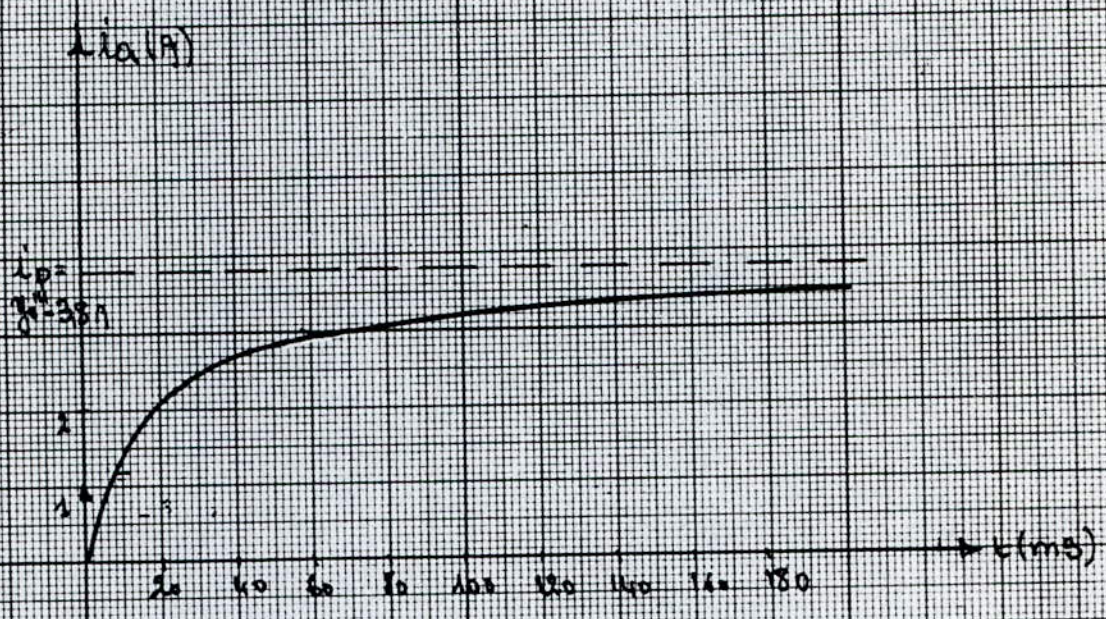
fig 17 d Enregistrement du courant dans la phase A de l'induit (circuit inducteur ouvert) - ESSAI 4 -
