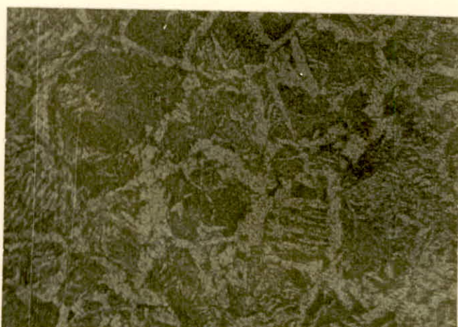
structure ferrite perlite v_R = 7^\circ\text{C/s} grossissement 500
