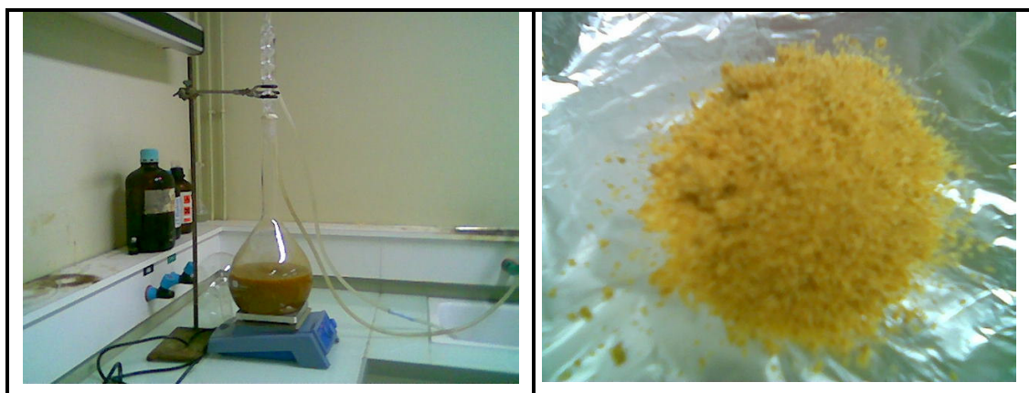
Figure 4 : Photos du dispositif expérimental utilisé et de la sciure traitée à la soude ( F_{OH} ).
