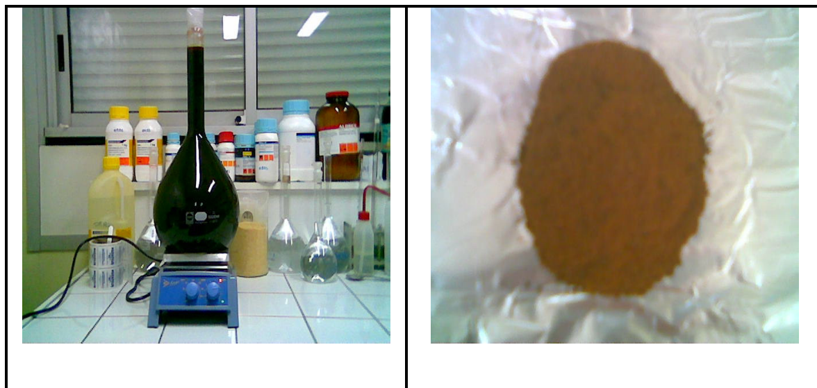
Figure 7 : Dispositif expérimental et produit obtenu dans le cas du greffage de la sciure.
